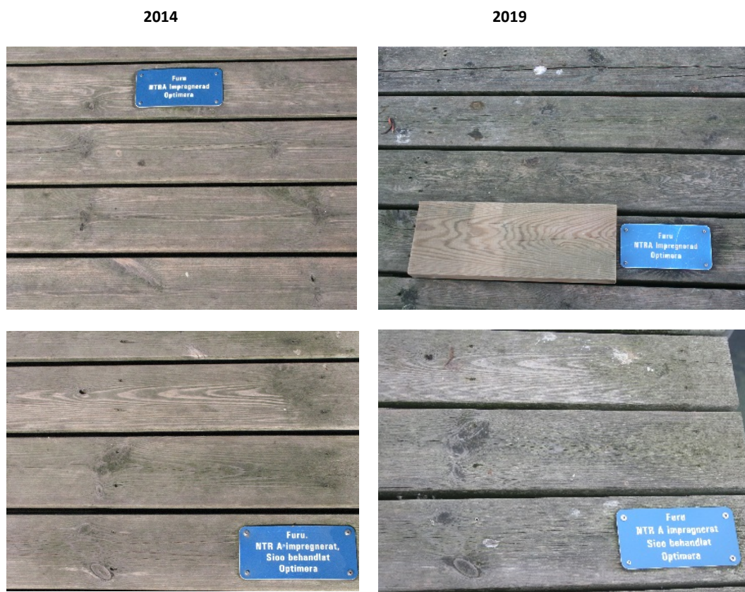
Övre rad: Impregnerat trä klass NTR A utan någon ytbehandling. Nedre rad: Impregnerat trä med ytlig behandling med Sioo.
