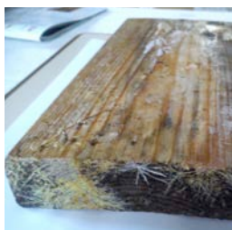
En bit kiselimpregnerad Organowood som legat på Tomas Nilssons tomt i 18 månader. Rötangreppen är omfattande. De vita trådarna är rötsvamp.
