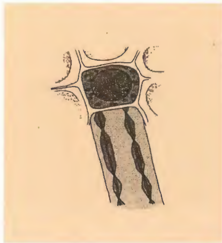
▲ Figur 14 Vedfiber angripen av soft rot. Skadebilden i tvärsnitt visar hålen i cellväggen, i längd- snittet ser man hålen som s k kaviteter i långa kedjor.
