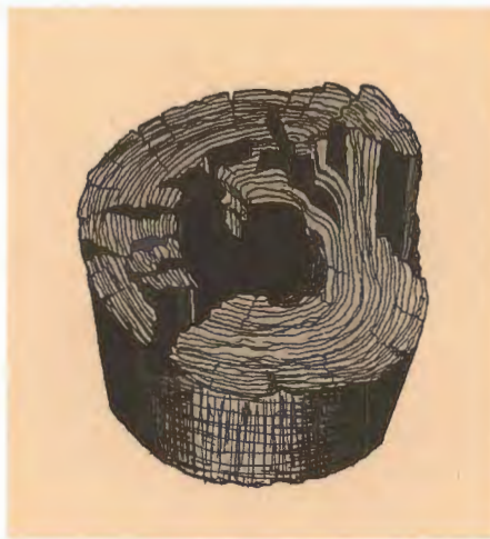
▲ Fig 15 Typiska "morotsbrott" orsakade av soft rot angrepp i en stolpe.
