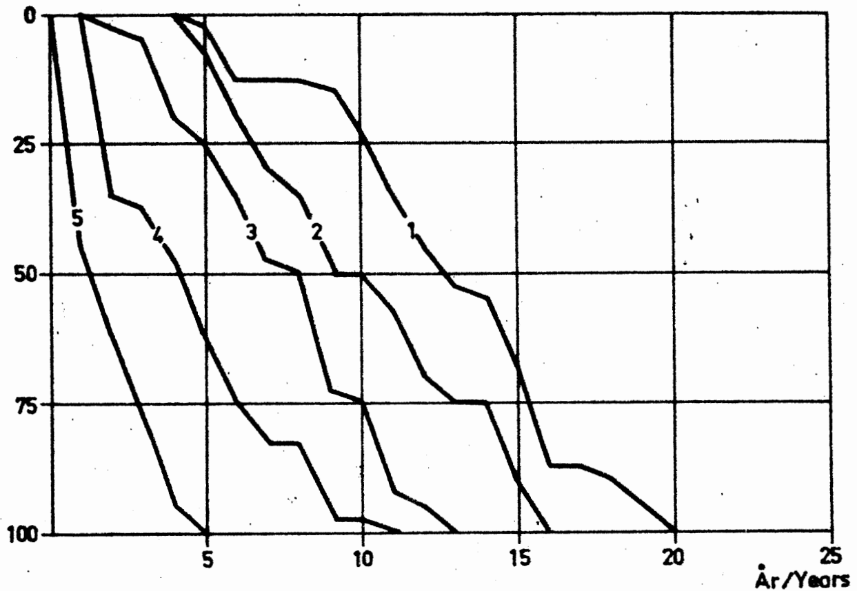
Fig. 1 a. Försök 1 A. Rötfförloppet hos stavar impregnerade med normalkvantiteten av Basilit UA (4), Bolidens salt BIS (2), Bolidens fluorsalt (3) och Kreosotolja (1) samt oimpregnerade stavar (5) på provfält nr. 1, Simlångsdalen.
