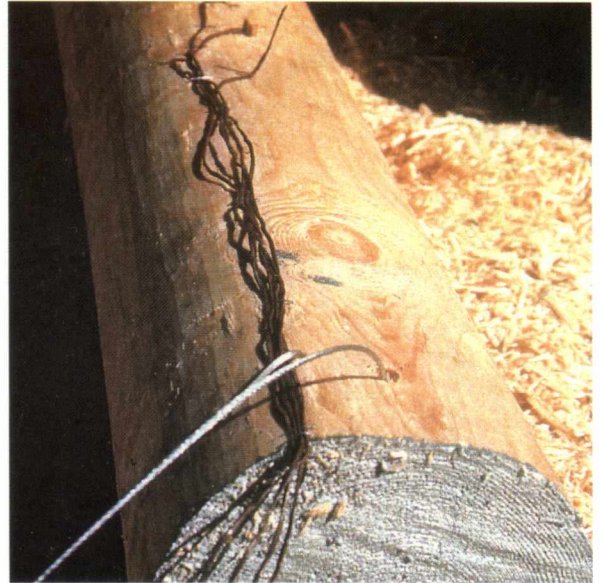
Figur 31. Stolpe klargjort for temperatur måling og veiing ved tørking i røkgass Figure 31. Temperature measuring in poles
