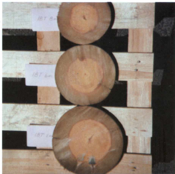
Figur 29. Eksempel på fullimpregnering i stolper tørket i overhettet damp
