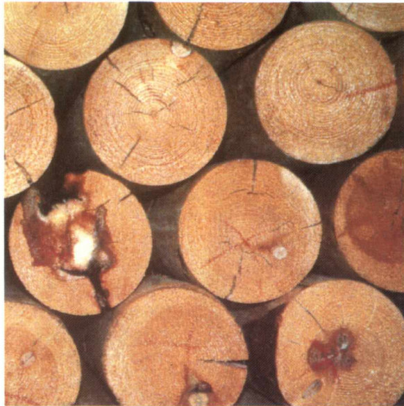
Figur 26. Endesprekk i stolper tørket i luft ved 80°C
