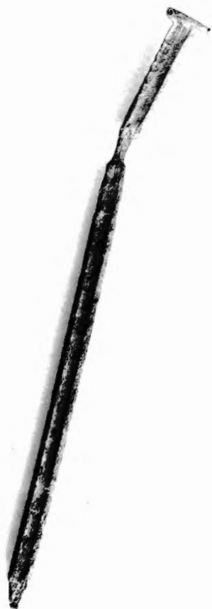
Bild 1. Midjebildning på spik av ordinärt kolstål. Waistline formation on nail of ordinary steel.
