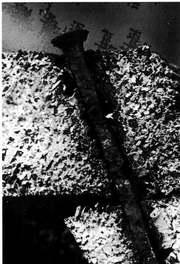
Bild 2. Korrosion av stålspik i oimpregnerat trä. Observera midjebildningar samt nedbrytning av träet pga bildade järnsalter. Corrosion of a steel nail in untreated wood. Notice the waistline formations and the deterioration of the wood due to decomposition of the cellulose by ferric salts.
