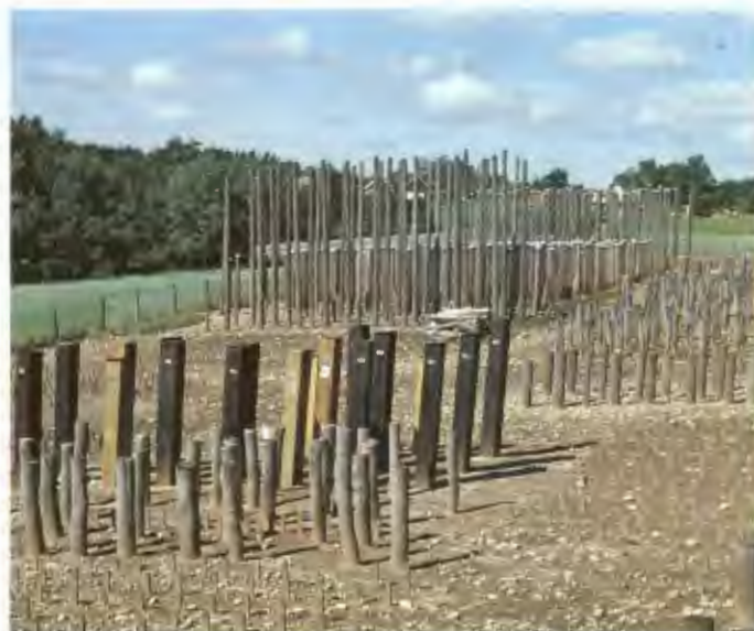
Fig 32. Innan ett träskyddsmedel godkänns, genomgår det omfattande provningar i laboratorium och i fält. Bilden visar försöksfältet i Simlångsdalen i Halland. Foto: Jöran Jermer.
