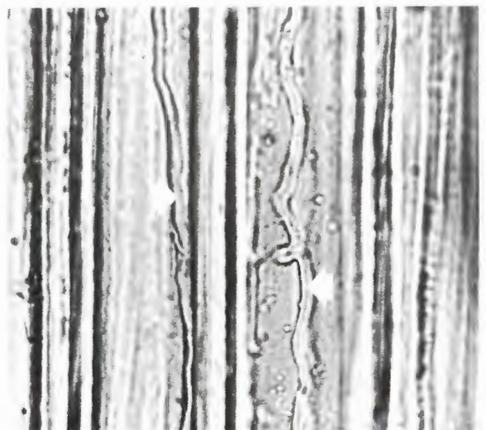
Fig 4 b. Fotograferat i mikroskop vid ca 875 gångers förstoring kan ett längdsnitt motsvarande figur 4 a se ut på detta sätt. Vid pilarna syns två hyfer, som växer i cellhåligheterna.
