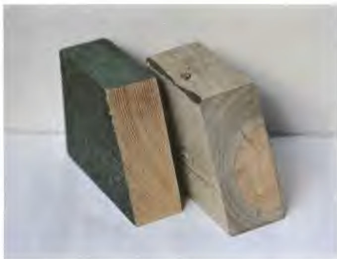
Fig 28. Jämförelse mellan furuvirke som tryckimpregnerats (th) respektive bestrukits med träskyddsmedel (tv).
