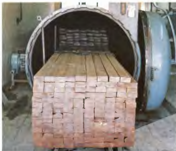
Fig 30. Impregnering av virke sker vanligtvis i stålcyllindrar, där träskyddsmedlet pressas in i träet under högt tryck. Foto: Stellan Jermer.
