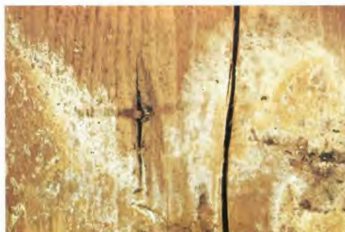
Fig 15. Fruktkroppar av källarsvampen. Det gulbruna området är det sporproducerande fruktskiktet, som är tätt tryckt till träytan. Foto: Jørgen Bech-Andersen, Hussvamp Laboratoriet ApS, Danmark.
