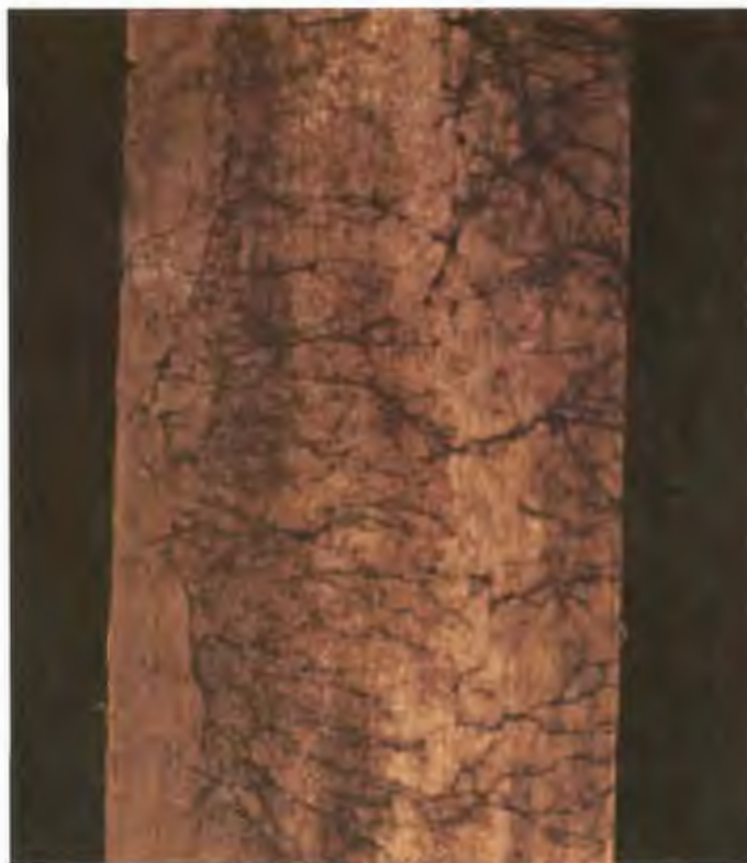
Fig 14. Källarsvampens mycel. Observera de rikt förgrenade mycelsträngarna. Foto: Björn Henningsson, Sveriges Lantbruksuniversitet.
