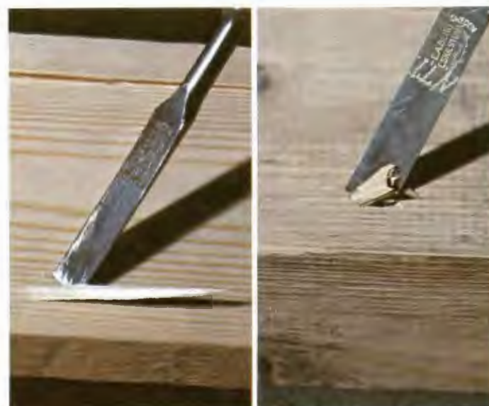
Fig 20. Friskt virke ger ett långt, spetigt brott, medan virke som angripits av röta spricker upp tvärt. Ur Evans & Klem: Trebeskyttelse.
