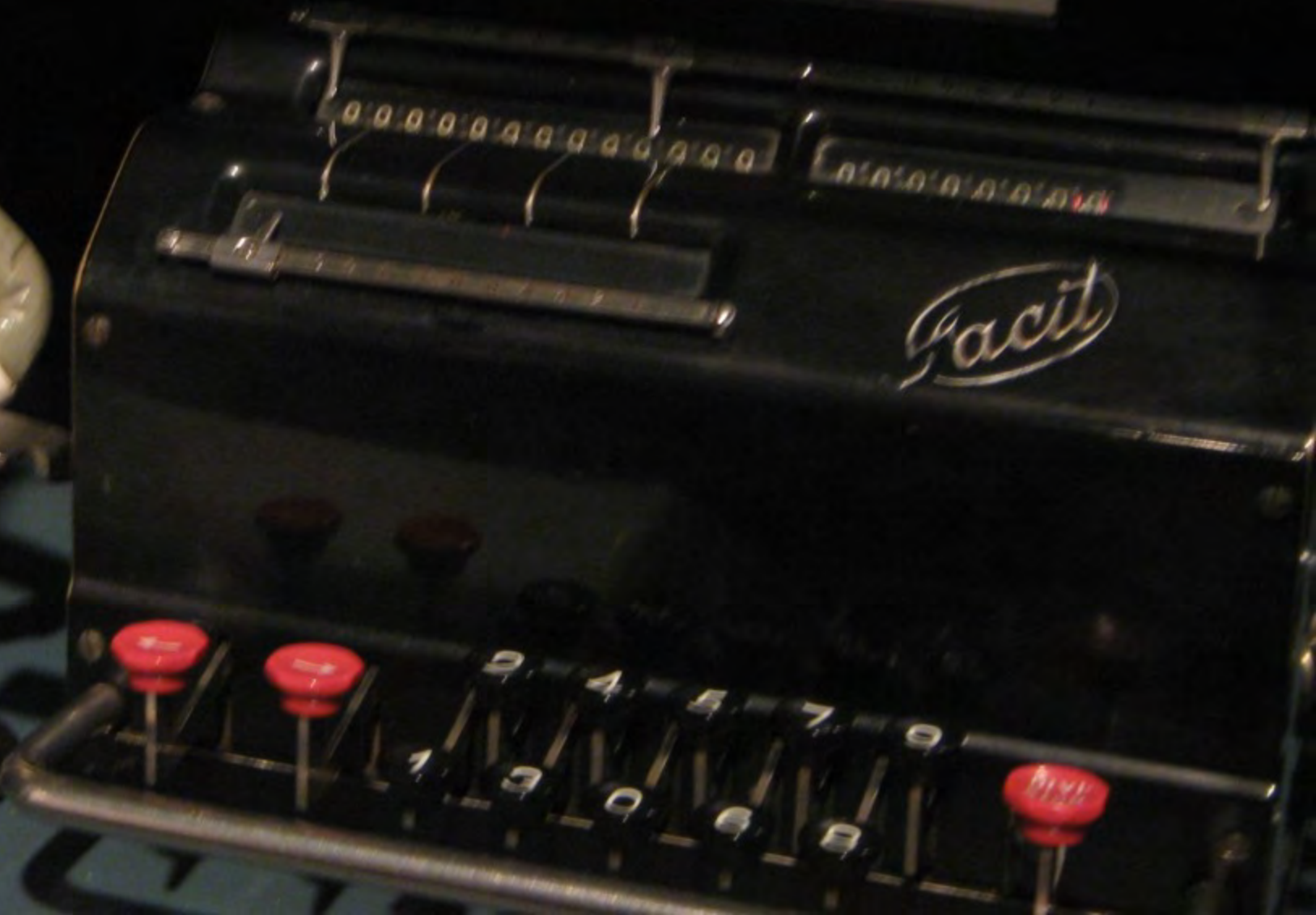
Facit modell TK 1936-54 Handmaskin försedd med s.k. glidande kyotkoppling, vilket inne- bär att utfyllnaden med nollor vid division inte längre behövs.
